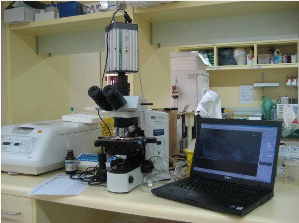
**Figura 11.** Microscopio óptico conectado a videocámara digital de alta velocidad a su vez conectada a ordenador para visualizar y grabar la motilidad ciliar. El microscopio óptico tiene una pletina con control de temperatura.
