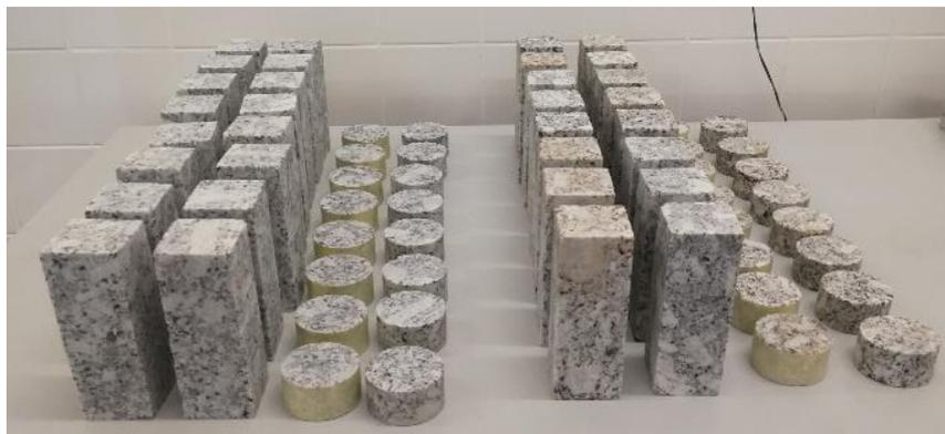
Figura 4.1.1: Provetes preparados para o projecto: provetes prismáticos GFTE e GATE, assim como discos GFTE e GATE.
