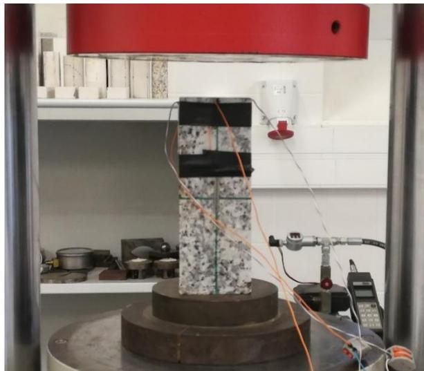
Figura 4.7.1: Provete GFTE na prensa hidráulica preparado para o ensaio de compressão uniaxial.
