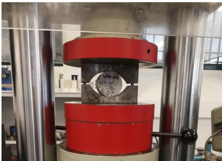
Figura 4.6.1: Prensa hidráulica com um provete de GFTE, em disco, para efectuar o ensaio brasileiro (tração).
