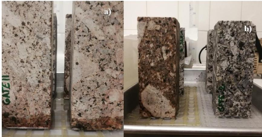
Figura 4.4.1: a) Provetes GATE num recipiente em água com 3 mm de profundidade, no início do ensaio. b) Provetes GATE e GFTE num recipiente em água com 3 mm de profundidade, no final do ensaio.
