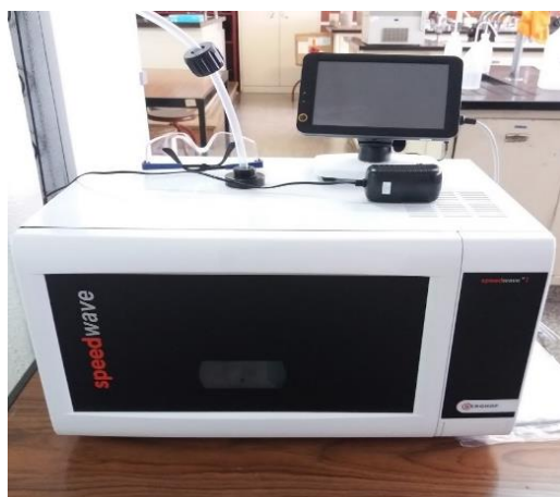
Figura 3.1 - Digestor de microondas (Berghof Speedwave Two): Equipamento usado para a digestão das amostras. Este modelo tem capacidade para 10 vasos.
