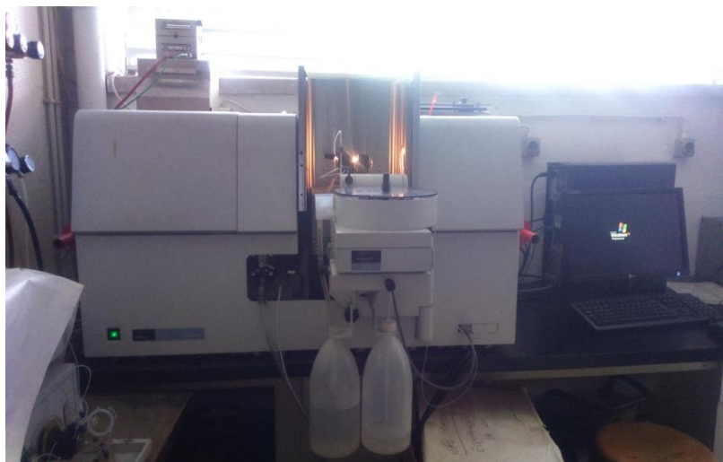
Figura 3.2 - Espectrofotômetro de Absorção Atômica com Forno de Grafite (PerkinElmer Instruments Analyst 700) com amostrador automático (Perkin Elmer Analyst 800).
