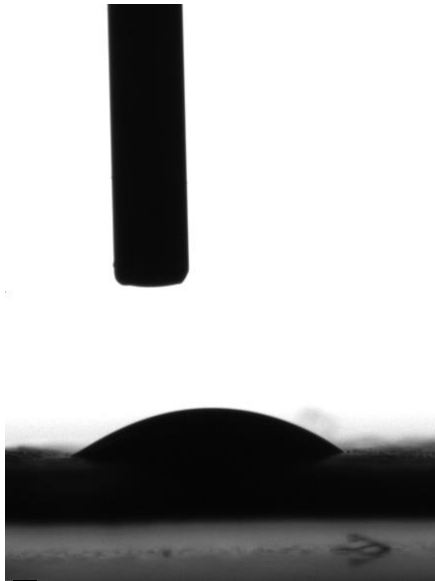
Figura 5.6: Gota obtida do elétrodo SIP-2 (protocolo S1, elétrodo n°2), 9 dias após o tratamento com plasma. Nesta gota, é fácil determinar a sua base, reduzindo a incerteza da medição realizada.
