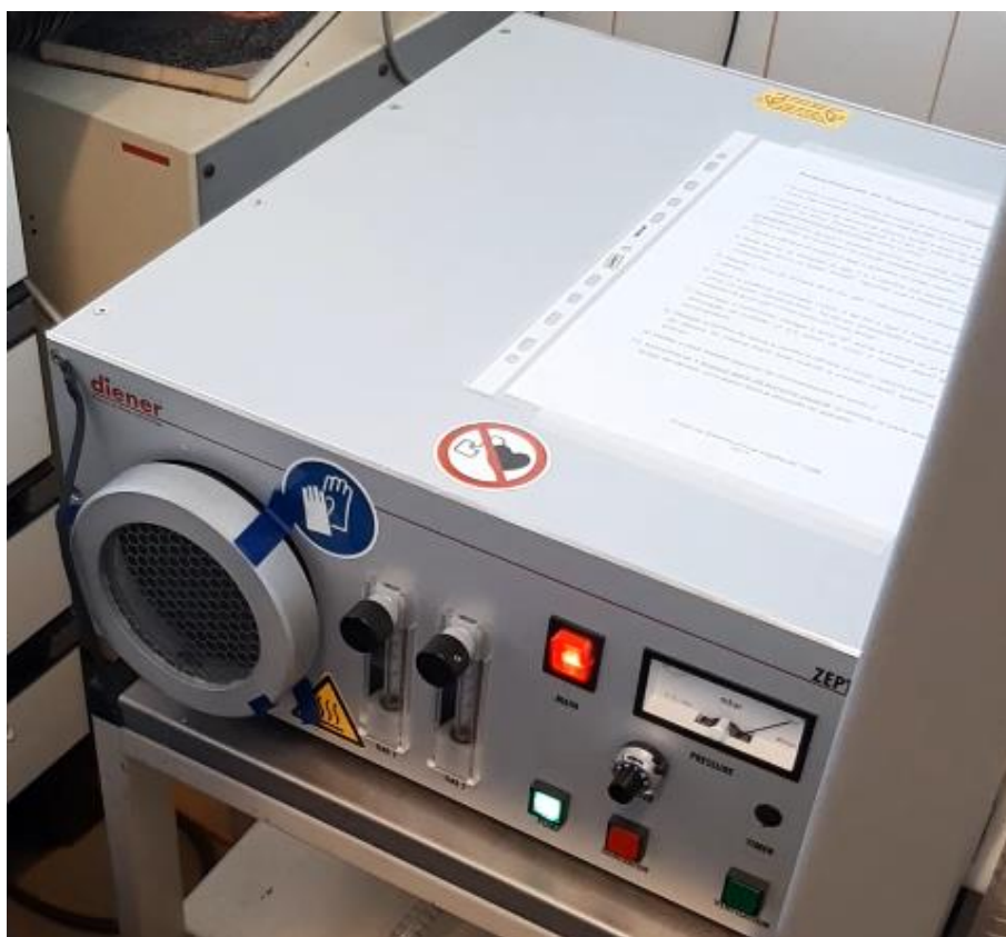
Figura 5.12: Equipamento utilizado para o tratamento com plasma dos elétrodo de CA. As amostras podem ser inseridas pela remoção da janela localizada no lado esquerdo.
