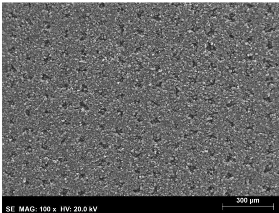
Figura 6.4: Fotomicrografia SEM de um elétrodo de CA-SI modificado por laser, com uma potência de 9 W.
