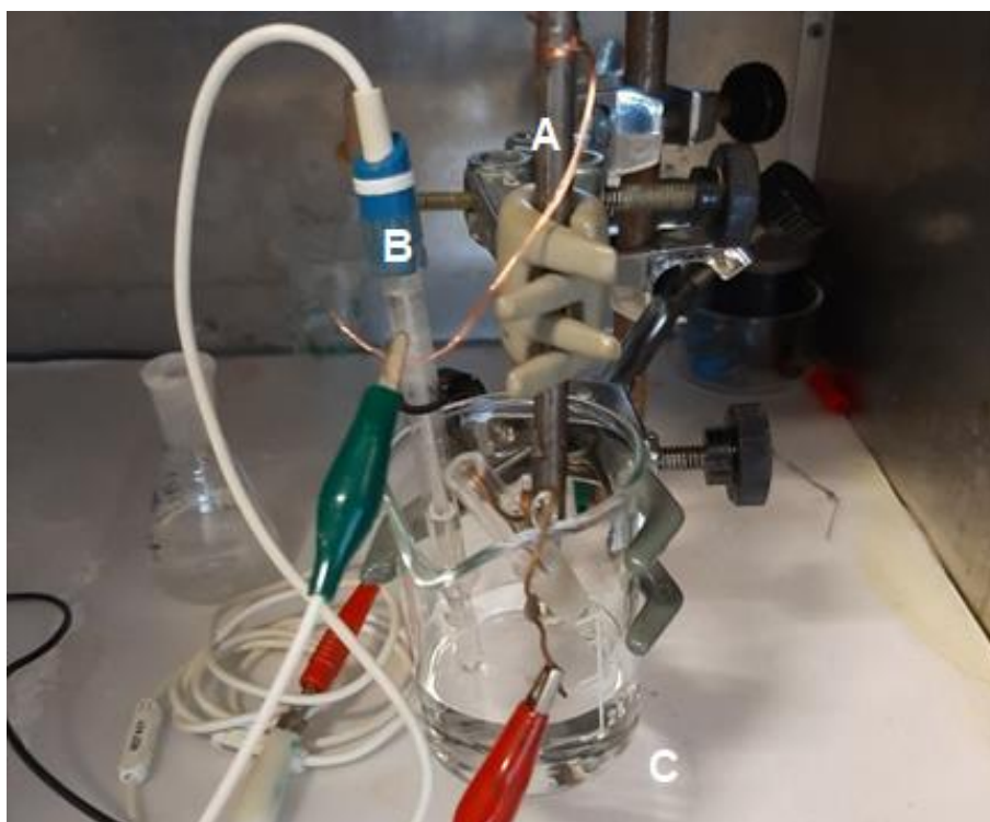
Figura 5.11: Montagem da célula eletroquímica dentro da caixa de Faraday. O eletrodo de trabalho encontra-se ligado ao contacto verde (A), o eletrodo de referência ao branco (B) e o contra eletrodo ao vermelho (C).
