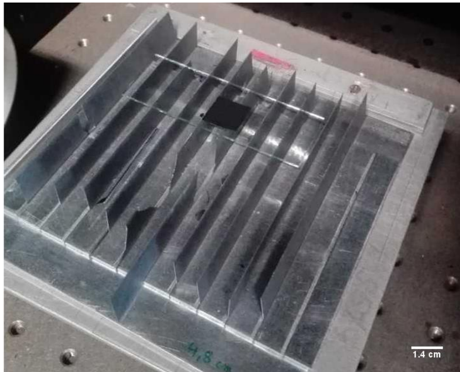
Figura 5.15: Suporte onde a amostra de CA (centrada na placa de vidro, em cima do suporte) é posicionada durante o tratamento com laser.
