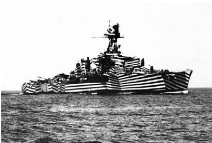
Figura 1 El Gloire de la armada francesa, camuflado con pintura dazzle , 1943 (Fotografía perteneciente al Archivo de R.R. Behrens).
