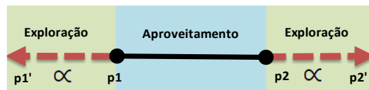
figura 6-1 Aproveitamento e exploração no operador de recombinação de indivíduos codificados por números reais.
