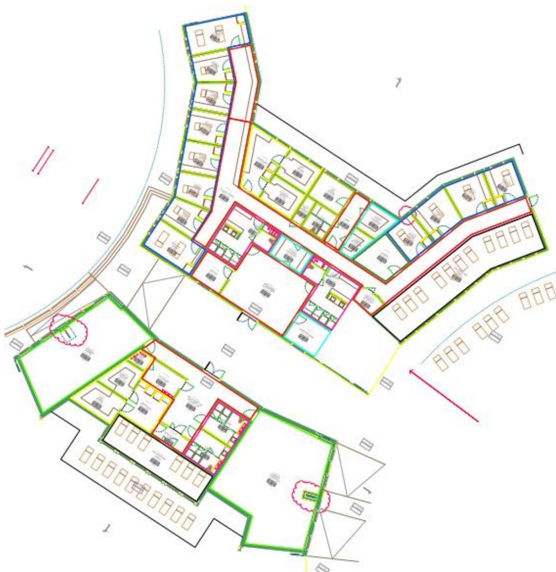
Figura 4.8 - Zonamento térmico edifício SPA&Wellness (F)
