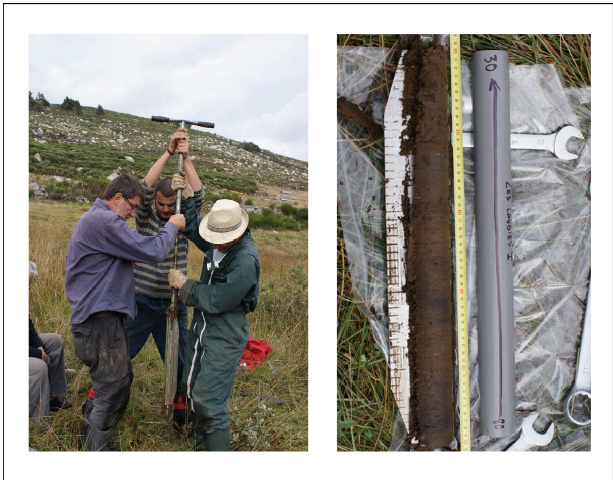
Fig. 19- Maniobra de sondeo en la secuencia de Laubies (izquierda) y detalle del sedimento extraído en la misma turbera con un cabezal tipo ruso (derecha). Fotografías: S. Paradis-Grenouillet.
