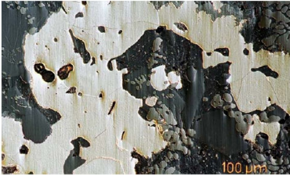
Figure 13: Filament métallique après attaque nital MO (GL04-07).
