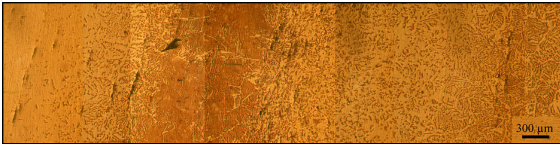
Figure 7 : Mise en évidence (attaque nital) de l'hétérogénéité de la teneur en carbone d'un fer de construction de la cathédrale Notre Dame de Rouen (ROU314) [50] 51 .
