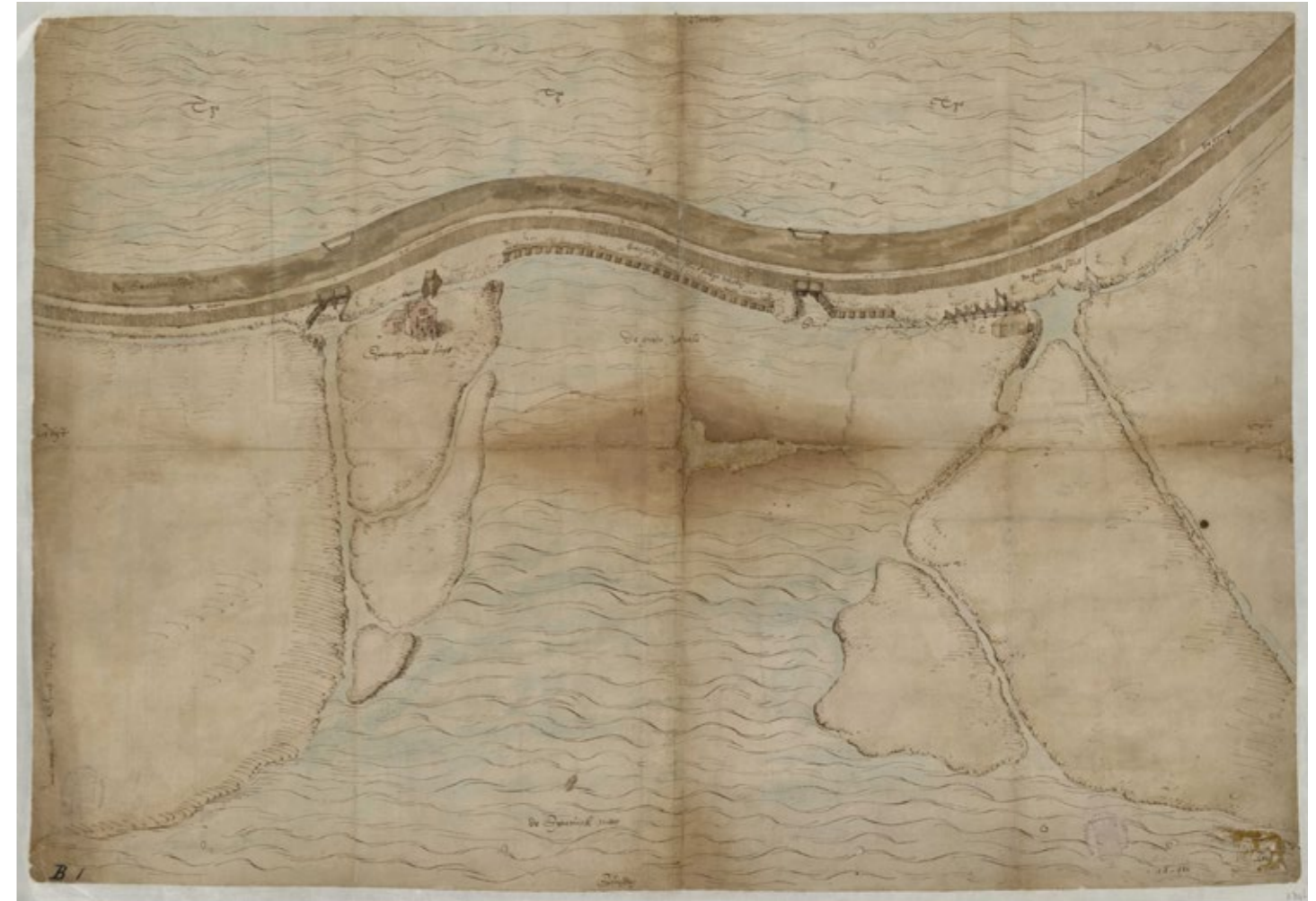
De Spaarndammerdijk bij Halfweg met links de Westsluis en rechts de Oostsluis, 1557. De oever aan de zuidkant is versterkt; op de linkeroever staat de keet die later uitgroeide tot het Gemeenlandshuis te Halfweg.
