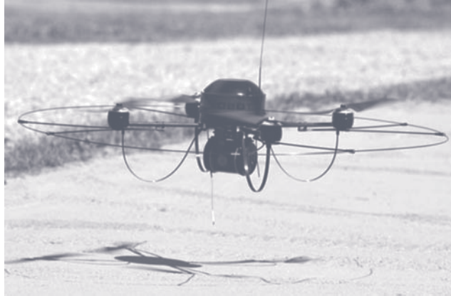
ABB. 3 MIKADO (AIRROBOT): MICRO-UAV FÜR DIE URBANE NÄCHSTFELDAUFKLÄRUNG
