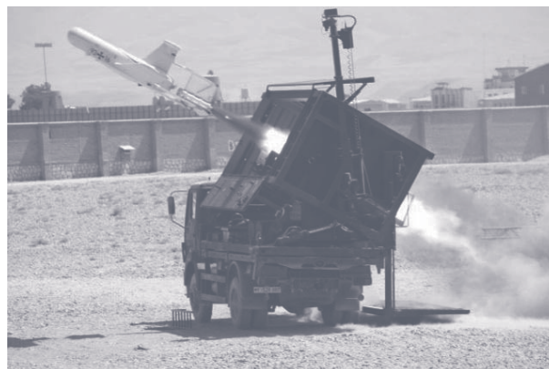
ABB. 6 KZO: MEDIUM RANGE UAV ZUR ZIELERFASSUNG UND TAKTISCHEN AUFKLÄRUNG
