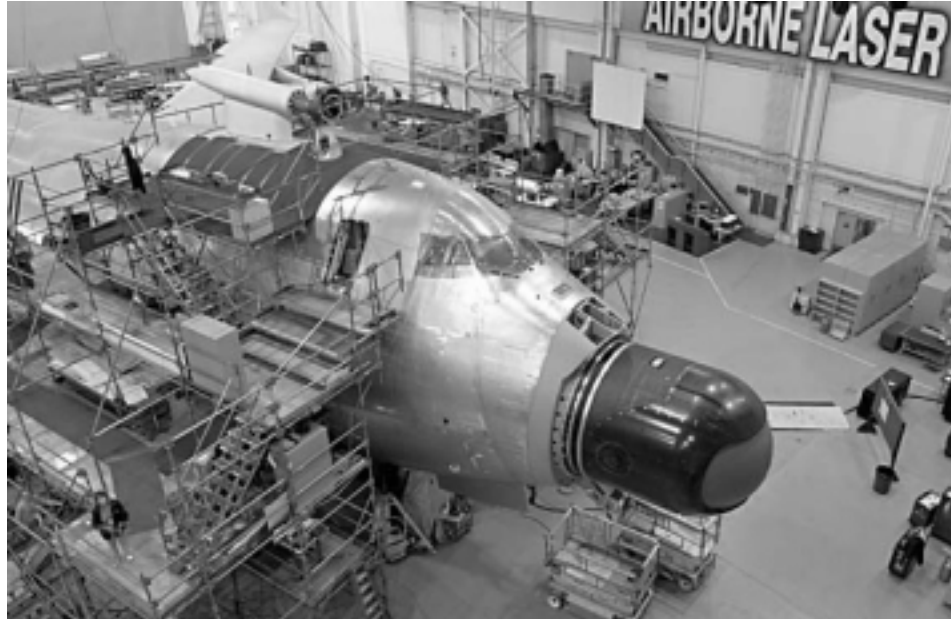
Abb. 15: Montage des Airborne Laser in einer Boeing 747-400F
