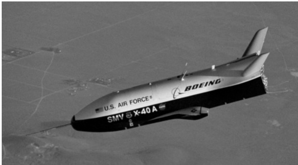
Abb. 3: X-40A, Technologiedemonstrator von USAF/Boeing für ein Space Maneuver Vehicle im freien Gleitflug
