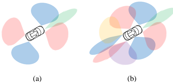
Abb. 5.3: Gruppierung des Sensoren für Nutzung gemeinsamer Ressourcen in (a) Setup III und (b) Setup IV.
