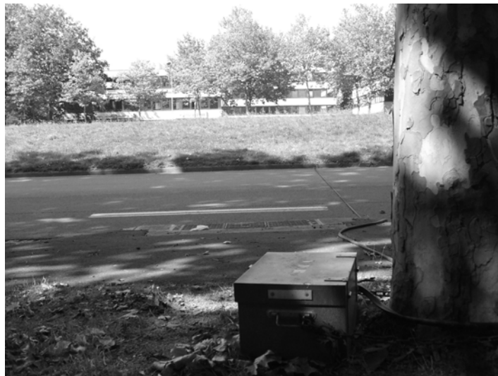
Photographie n°4 : Une boucle de comptage mobile à Rennes
