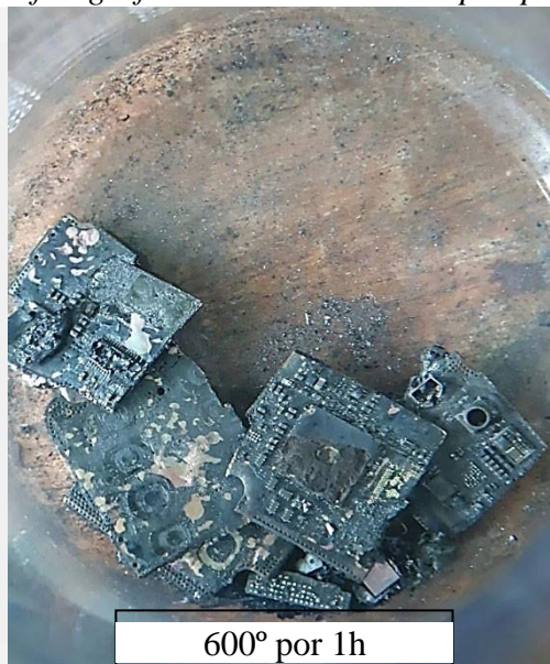
Figura 9: Amostra 1 fotografada através de uma lupa após a carbonização
