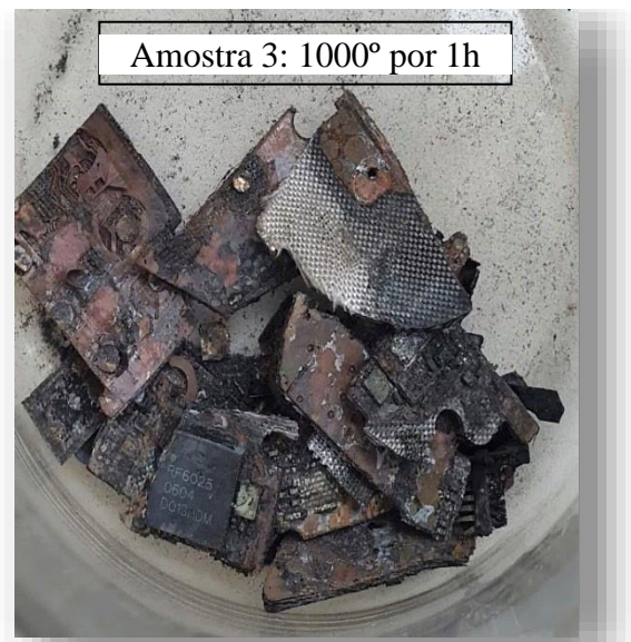
Figura 11: Amostra 3 fotografada através de uma lupa após a carbonização
