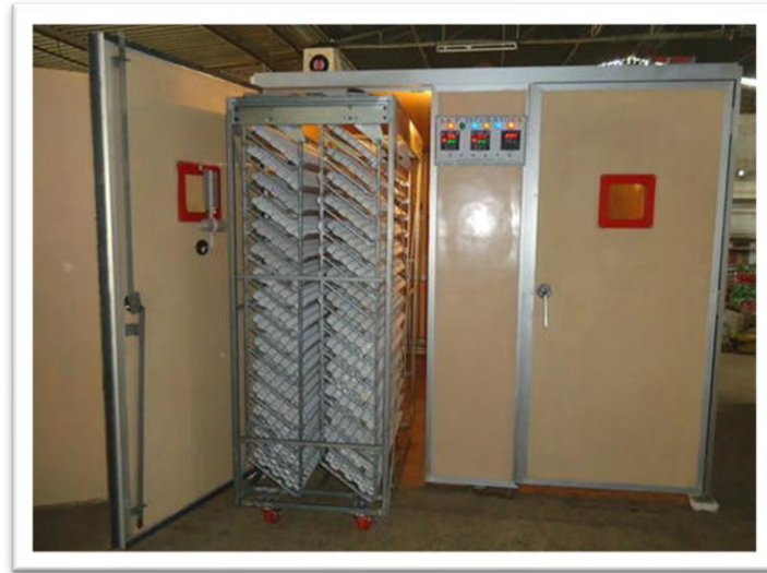
Figura 11 – Incubadoras industriais de ovos de galinha.
