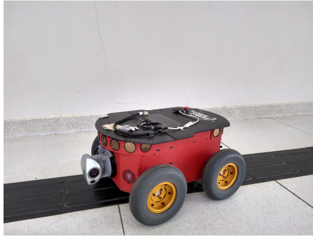
Figura 6.1: Posição da Câmera na estrutura do Pioneer 3AT
