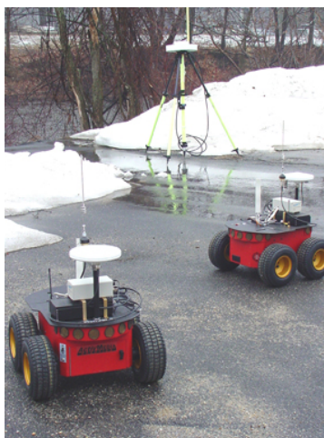
Figura 4.1: Pioneer 3AT - Robô utilizado para coleta de dados e implementação de comportamentos reativos [9].
