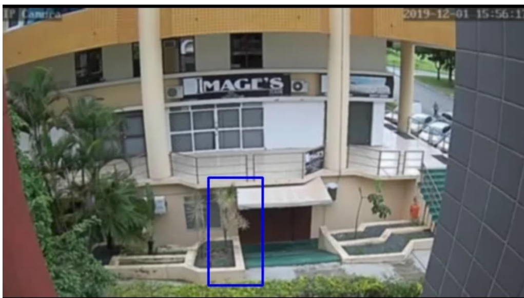
Figura 4.3: Planta sendo detectada como um ser humano, levando o sistema a falhar.
