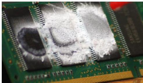
Figura 2.11: Ataque por impressão de temperatura [13].
