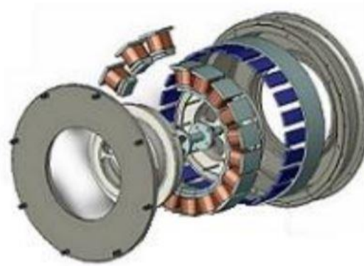
Figura 2.8 - Motor de ímã permanente de fluxo radial [67]
