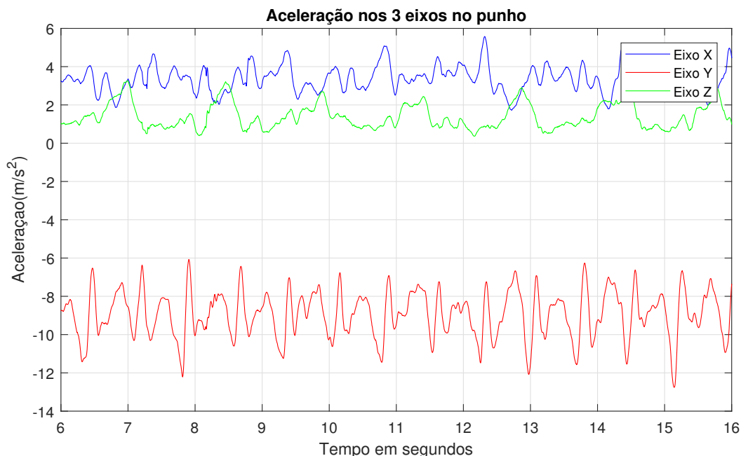
Figura 2.4: Aceleração dos 3 eixos X,Y e Z, com o acelerômetro fixado no punho.
