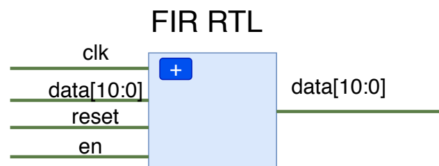
Figura 21 – Interface RTL do filtro FIR.
