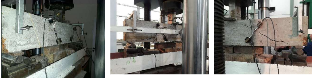
Figura 4: Desarrollo de ensayos sobre vigas de hormigón armado.
