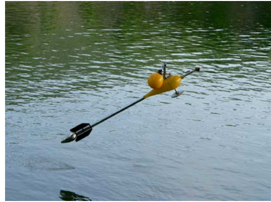
Abb. 6: Hydrometrischer Flügel an einem 100-kg-Schwimmkörper
