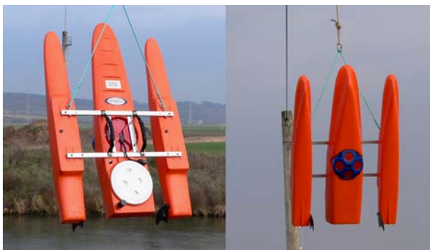
Abb. 7: ADCP-Messgerät RioGrande mit dem Geräte-träger Riverboat der Firma Oceanscience
