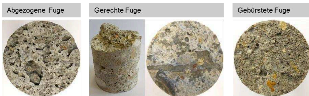
Bild 22: Exemplarisch beobachtete Bruchoberflächen nach Haftzugversuch; gemäß Tabelle 7 Serie 1 (links), Serie 2 (Mitte) und Serie 3 (rechts)
