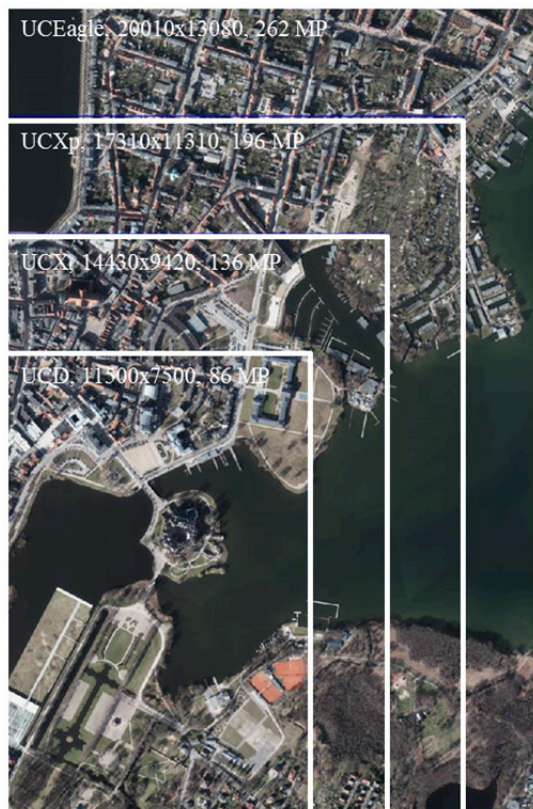
Abb. 1: Vergleich der Aufnahmebereiche der verschiedenen UltraCam-Kameragenerationen
