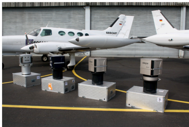
Abb. 1: Flugzeuge und metrische Kamerasensoren zur Erfassung von Luftbildern
