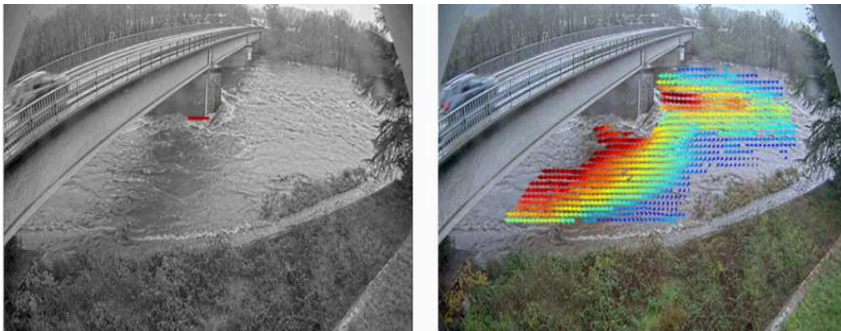
Abbildung 4: Gemessenes Oberflächengeschwindigkeitsfeld während eines Hochwasserereignisses
