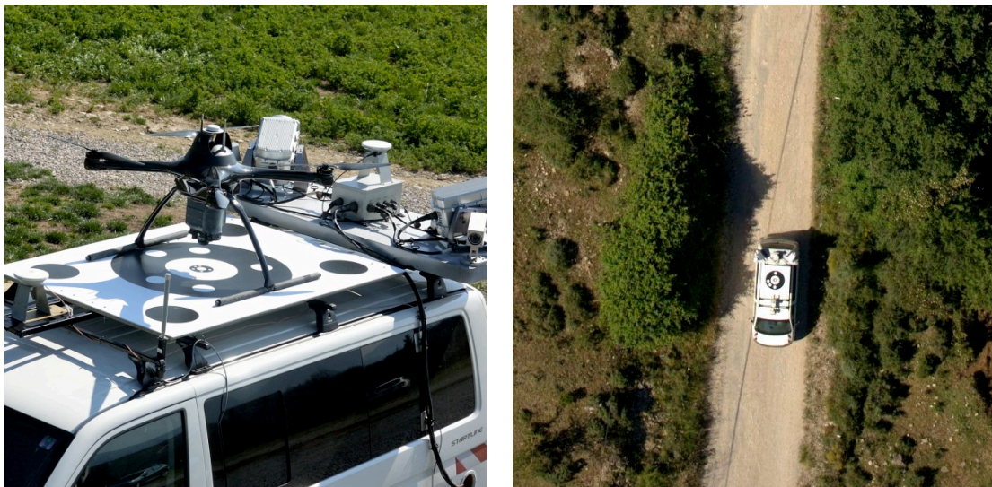
Abb. 3: mapKITE Mobile Mapping System bestehend aus der Flugplattform (Quadrocopter Spyro-4, UAVision (Portugal)) und dem terrestrischen Fahrzeug mit Messausrüstung. Das kodierte Signal dient als kinematischer Passpunkt. Das Bild rechts zeigt einen Ausschnitt aus dem Bild der UAV-Kamera mit dem kinematischen Passpunktsignal (Fotos: P. Molina, Castelldefels).
