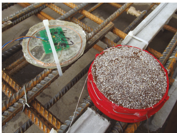
Abbildung 7: Feuchtesensoren der Bundesanstalt für Materialforschung und -prüfung und BS2 Sicherheitstechnik GmbH (links); Auswertung der Feuchtesensoren der BS2 Sicherheitstechnik GmbH von 2016 bis 2019 (rechts).
