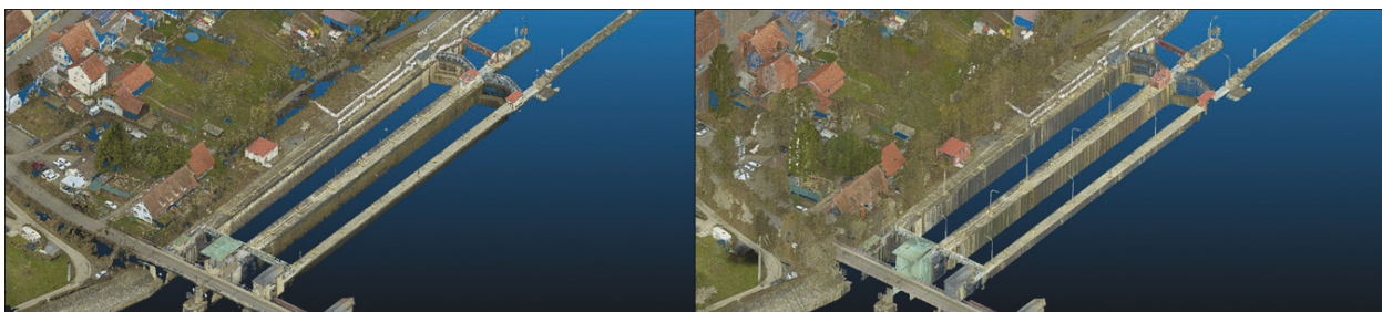
Abbildung 13: Colorierte Punktwolken aus der UAS-Befliegung mittels Kamera- (links) und Lasersensoren (rechts) (Quelle: Institut für Photogrammetrie der Universität Stuttgart).
