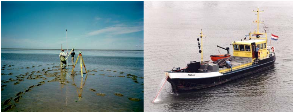
Abb. 3: Geometrisches und hydrostatisches Nivellement
