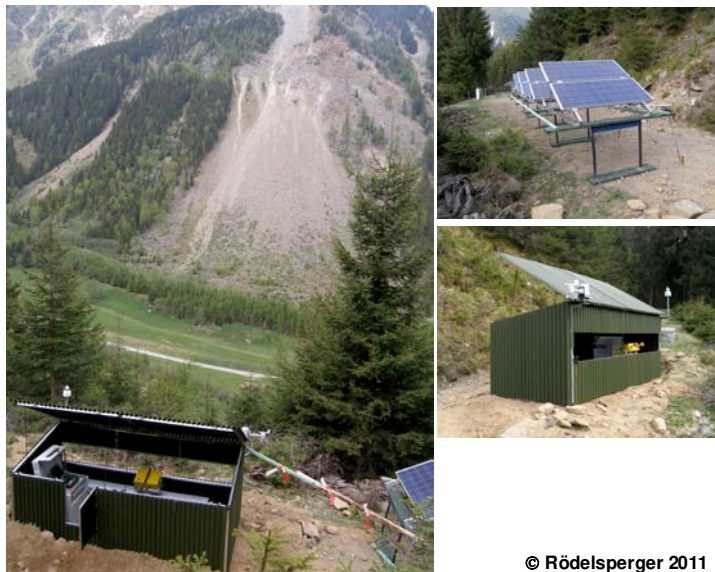
Abb. 2: Monitoringsystem IBIS-L an der Massenbewegung Steinlehen.
