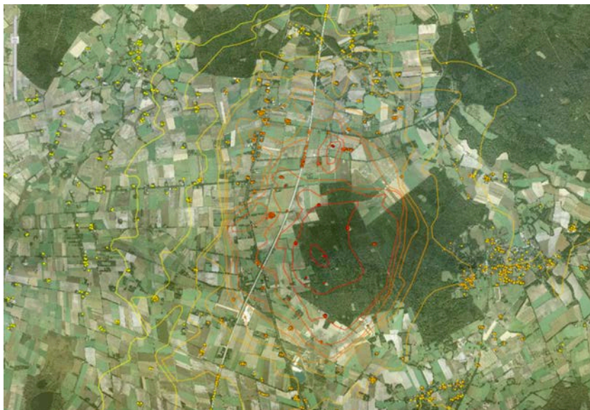
Abb. 9: Persistent Scatterer und Isolinien mit einer Äquidistanz von 1 mm/Jahr im Bodenbewegungsgebiet Hengstlage
