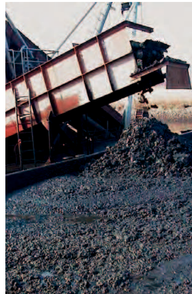
Abb. G 48a + b: Aufnahmegert für Baggergut mit Förderung in Schuten
