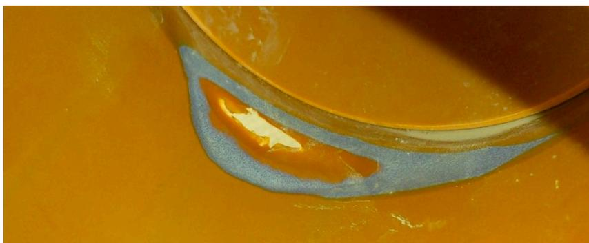
Abbildung 7-2: Durchbruch eines KG-Rohrs
