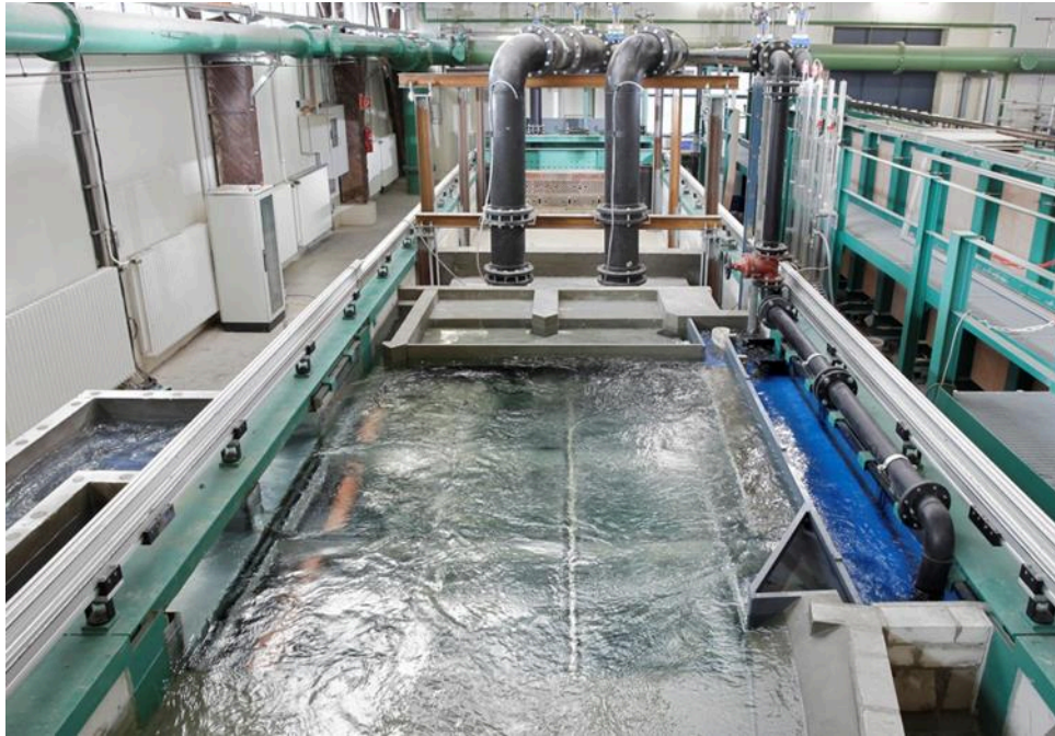
Bild 9: Gegenständliches Modell der Wasserkraftanlage Lauffen/Neckar mit geplantem Einstieg der Fischaufstiegsanlage, Blick vom Unterwasser in Richtung der Wasserkraftanlage (BAW 2019c)
