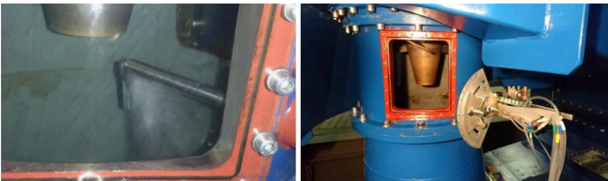
Bild 2: Fähnchensondenmessung unterhalb des Laufrades der Turbine (links; TUM 2016a); Versuchsaufbau mit Conradsonde (rechts; TUM 2017b)
