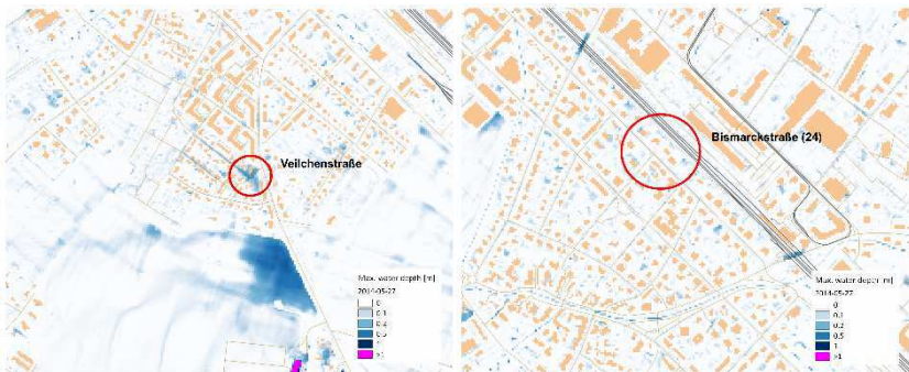
Abbildung 3: Vergleich der simulierten maximalen Überflutungshöhen am 27.05.2014 im Lockwitzbachgebiet mit gemeldeten Hochwasserschäden.
