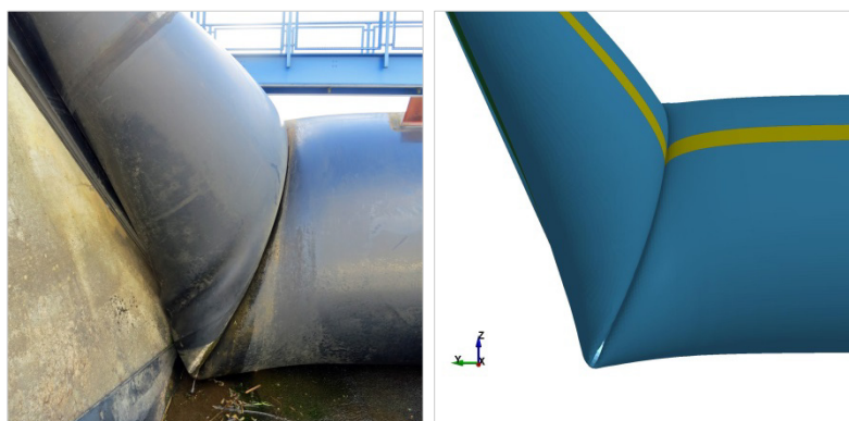
Bild 1: Realität und Simulation des Faltenbereichs im Vergleich, Blick von Unterwasser.
