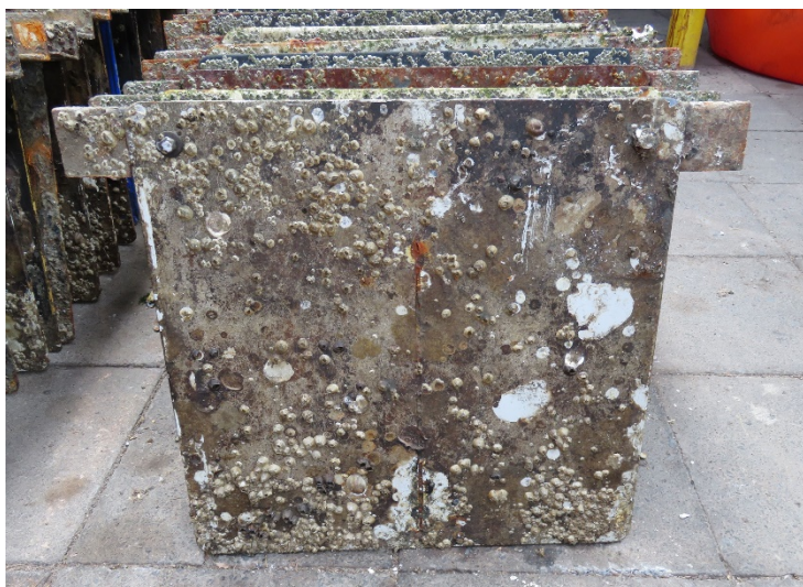
Bild 1: Probeplatten nach der Naturauslagerung.
