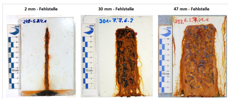
Bild 1: Laborprobenplatten mit verschiedenen hergestellten Fehlstellenbreiten nach der Belastung in der Salzsprühnebelkammer.
