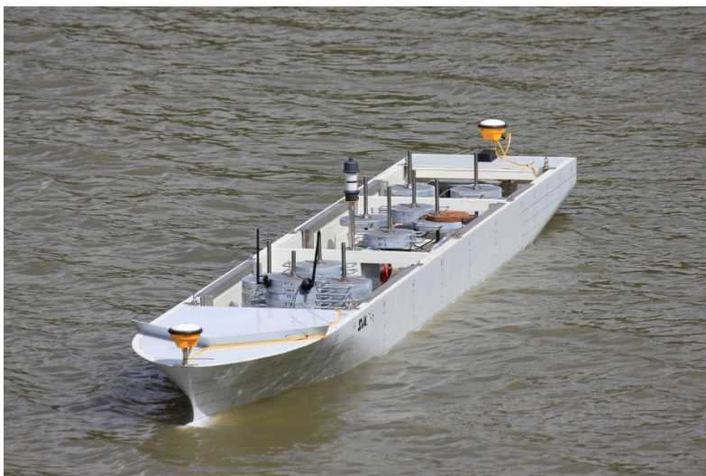
Bild 1: Schiffbauliches Modell (Containerschiff, 14000 TEU (DTC)) im Maßstab 1:60 das freifahrend manövriert.
