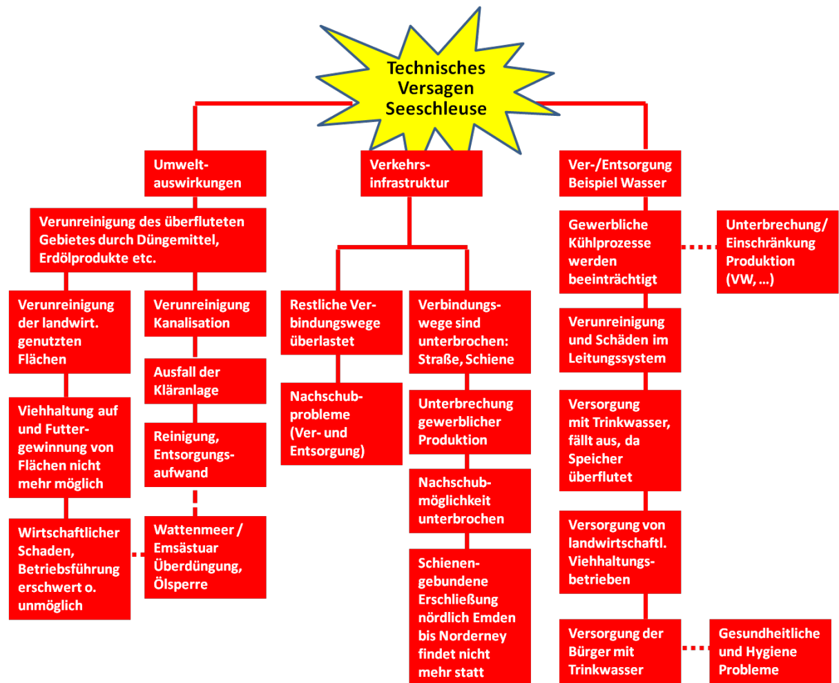
Abbildung 4: Versagenskaskade „Technisches Versagen Seeschleuse“.
