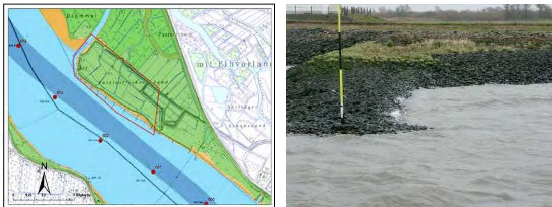
**Abb. 9:** Anwendungsbeispiel Twielenflether Sand/Juelssand; links: das Untersuchungsgebiet ist rot umrandet, der Bereich der Fahrrinne ist dunkelblau dargestellt; rechts: Detailanschnitt mit Buhne und Ufersicherung
