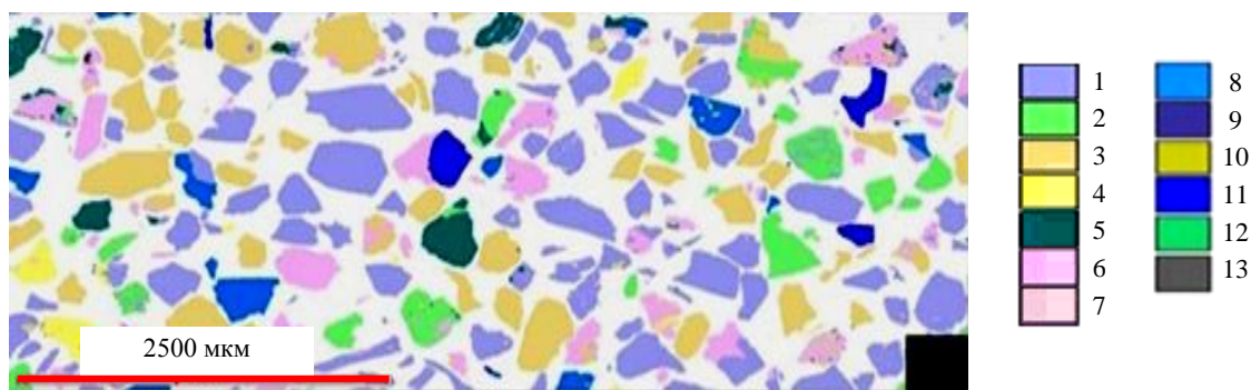
Рис.3. Образец фосфатной руды магматического происхождения 1 – нефелин, кальцит; 2 – полевой шпат; 3 – апатит; 4 – слюда; 5 – силикаты натрия; 6 – пироксены; 7 – цеолиты; 8 – титаносодержащие минералы; 9 – минералы РЗЕ; 10 – сульфиды; 11 – магнетит, титаномагнетит; 12 – оксиды и гидроксиды железа; 13 – другие минералы
