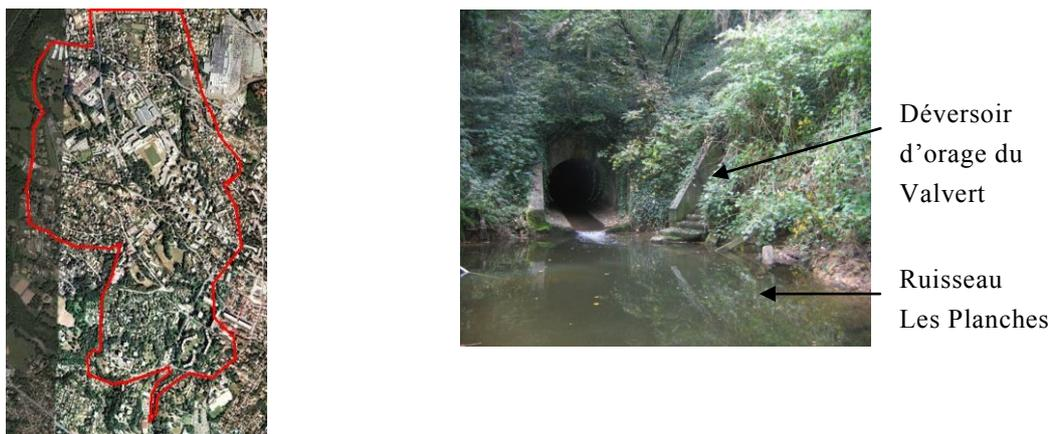
Figure 7.4. A gauche : Vue aérienne du bassin versant d'Ecully. A droite : Photo du point de rejet du DO Valvert à l'aval du bassin versant
