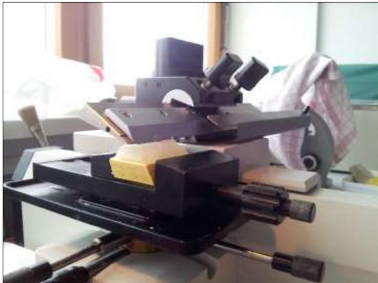
Abb. 15: Schneidvorgang der in Paraffin eingebetteten Felsenbeine mittels Mikrotom.
