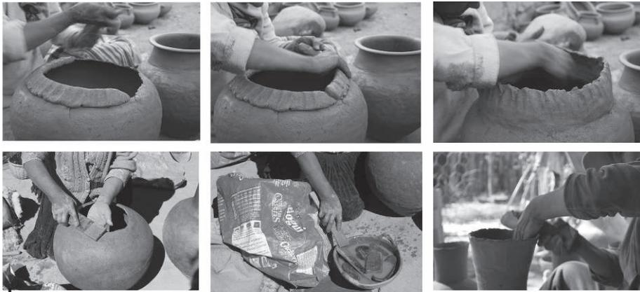
Figura 2 – Proceso de levantado de las piezas
