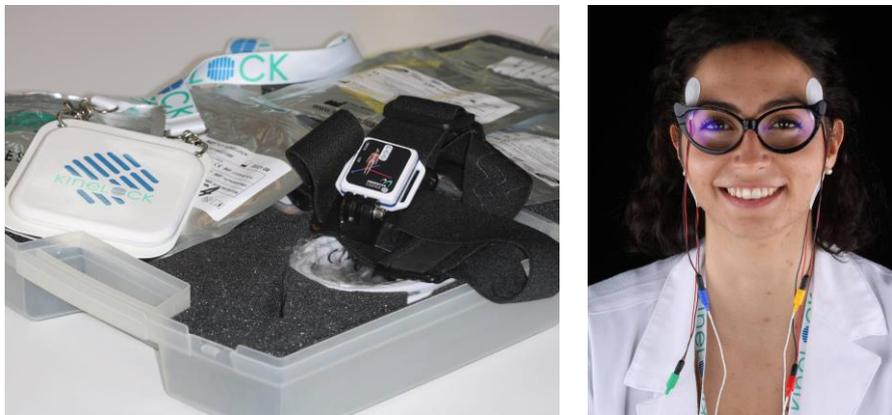
**Figura 24.** Electromiógrafo de superficie modelo KineLock® de QuattroTi y acelerómetro modelo SysMotion Cerv de Microlab Italia. (Cavassa, 2021).
