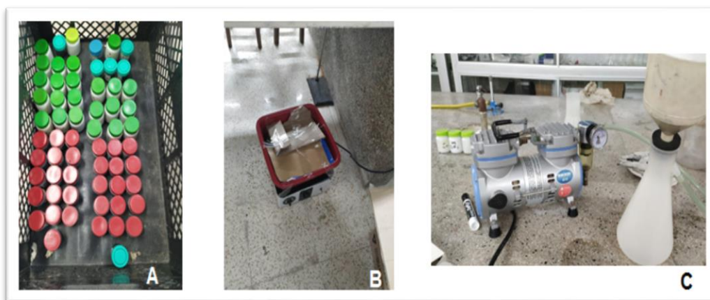
Figura 12 Procesamiento de las muestras. (A) Muestras realizadas (B) Agitación en Shaker (C) Filtración de muestras. Fuente: Autor.
