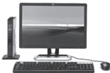
Figura 31. Equipo Thin Client
