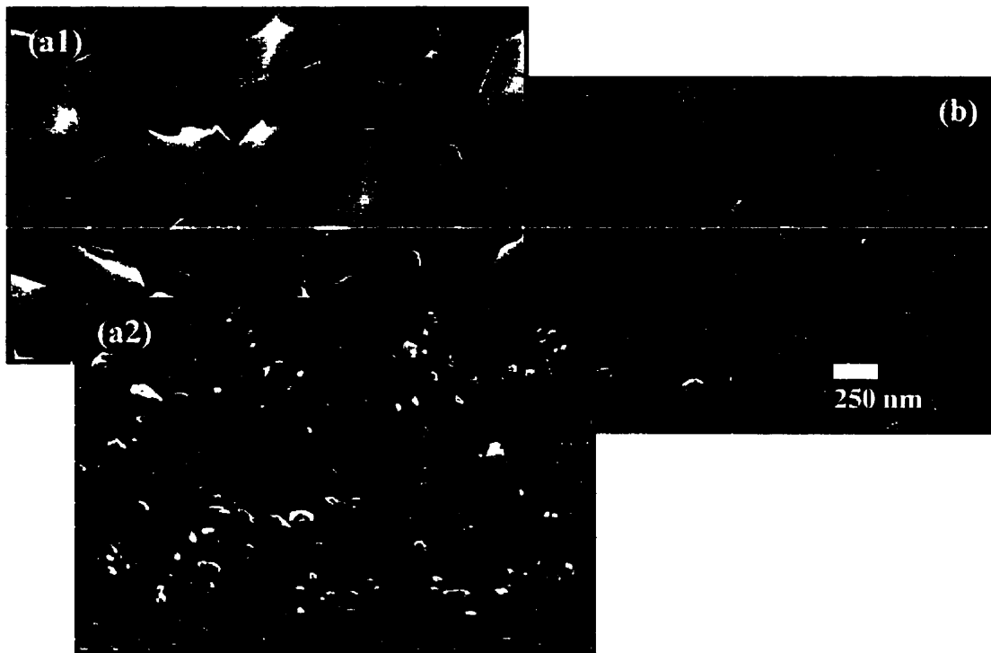
Figure 4.71 : Détails de la morphologie de la couche d'interface riche en aluminium d'un revêtement (a1 et a2) non-recuit et (b) partiellement recuit (4,5 s @ 460°C). – Substrat : ULC – Immersion : 3,5 secondes - Bain : 0,16% Al.
