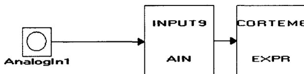
Figure 7.13 : La description du parcours des données pour déterminer la température à l'entrée de la pompe en CS.
