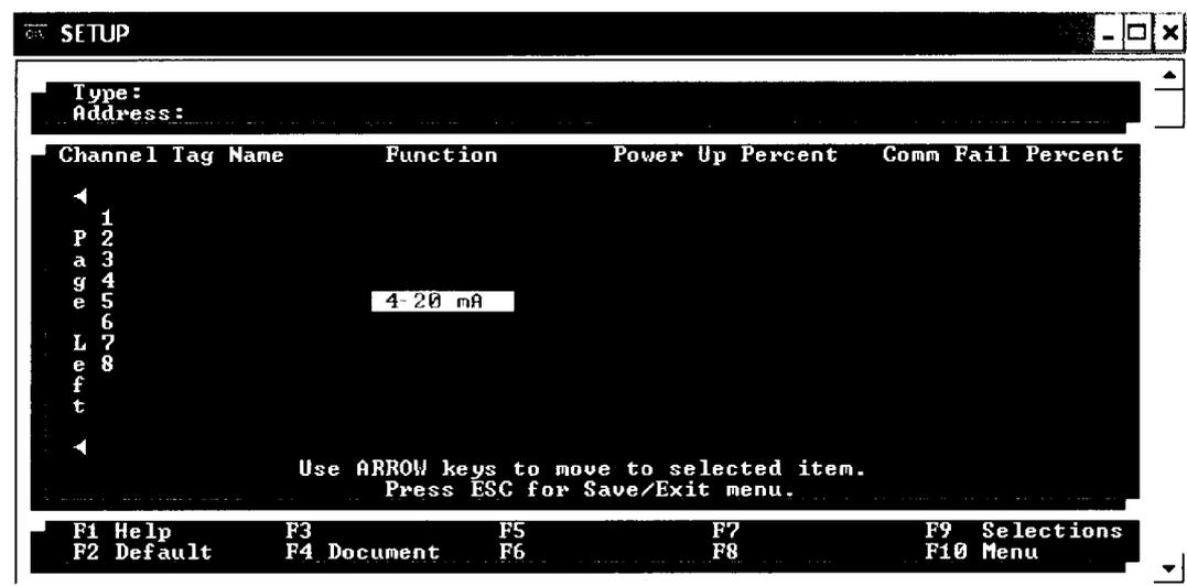
Figure 7.4 : La configuration du module de sortie analogique.
