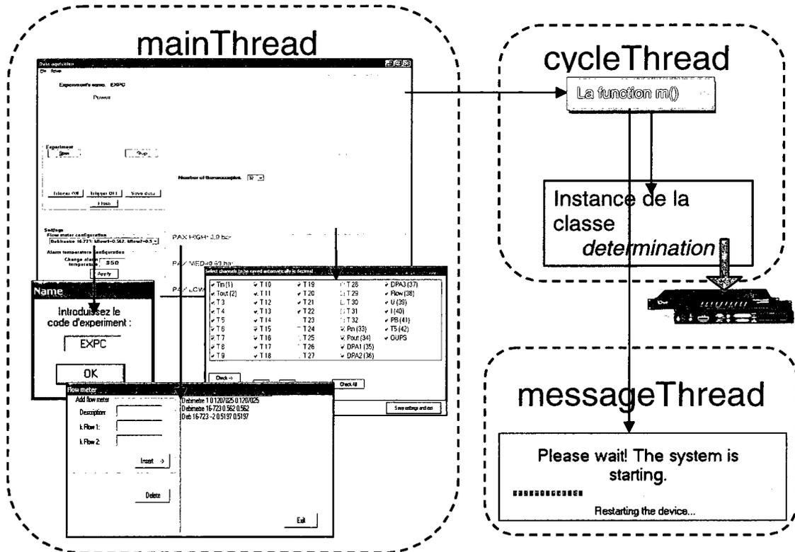
Figure 4.1 : Les fils d'exécution de l'application.
