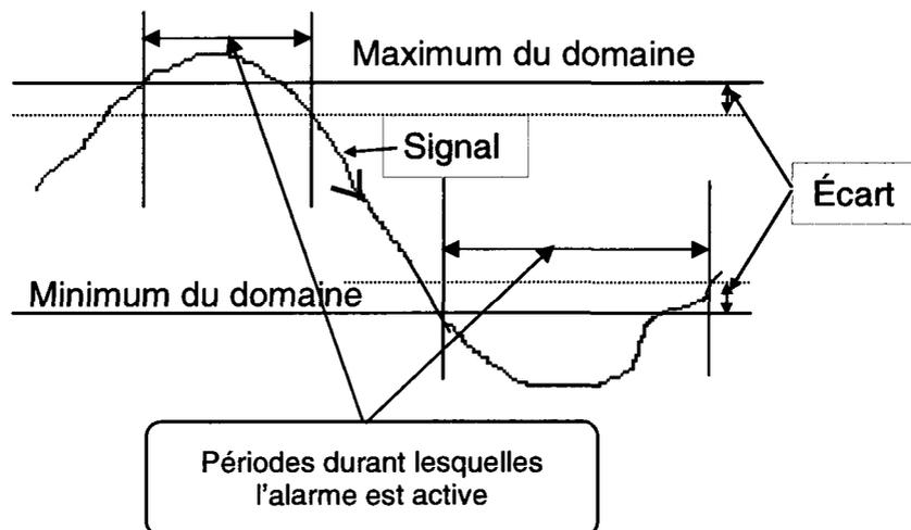
Figure 2.2 : Exemple qui montre le principe de fonctionnement des alarmes.
