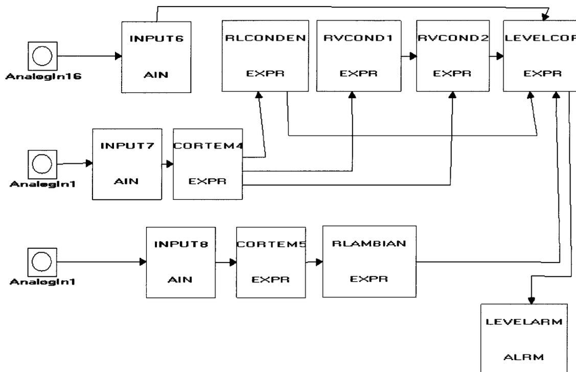
Figure 7.12 : La description du parcours des données déterminer le niveau du liquide dans le ballon condenseur en CS.
