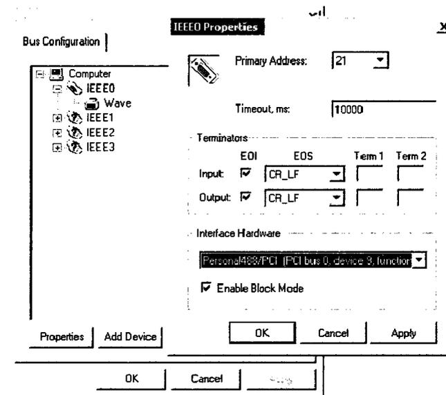
**Figure 3.1 : Interface de configuration des cartes IEEE-488 et des équipements branchés.**
