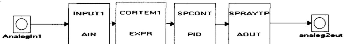
Figure 7.7 : La description du parcours des données pour contrôler le débit du spray en CS.
