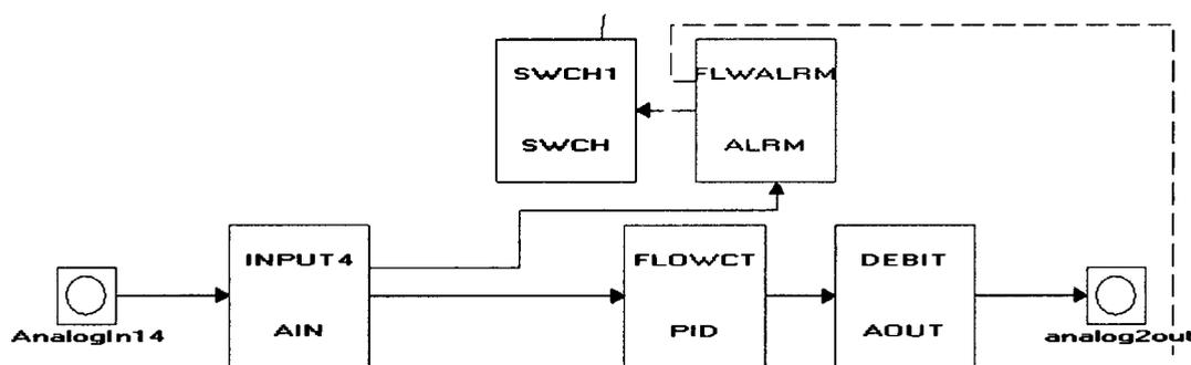
Figure 7.10 : La description du parcours des données pour contrôler le débit massique en CS.
