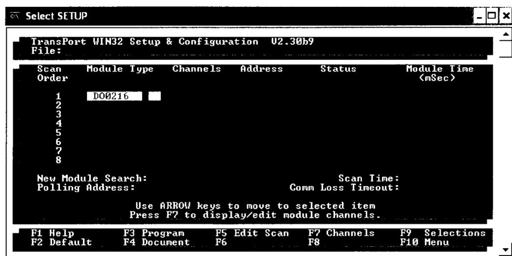
Figure 7.1 : Interface de configuration des modules de branchement du réseau TransNet.
