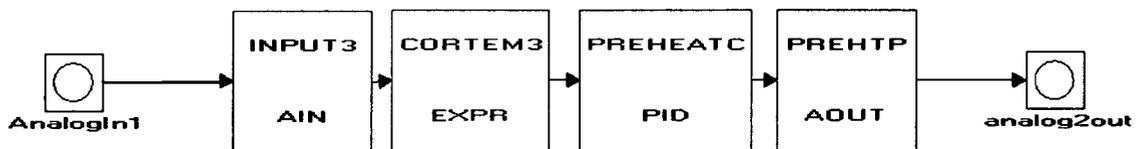
**Figure 7.9 : La description du parcours des données pour contrôler la puissance électrique dans le préchauffeur en CS.**
