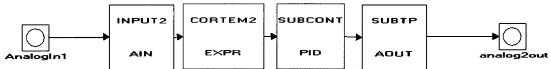
**Figure 7.8 : La description du parcours des données pour contrôler la vanne de mélange à la sortie de l'échangeur de chaleur CS.**
