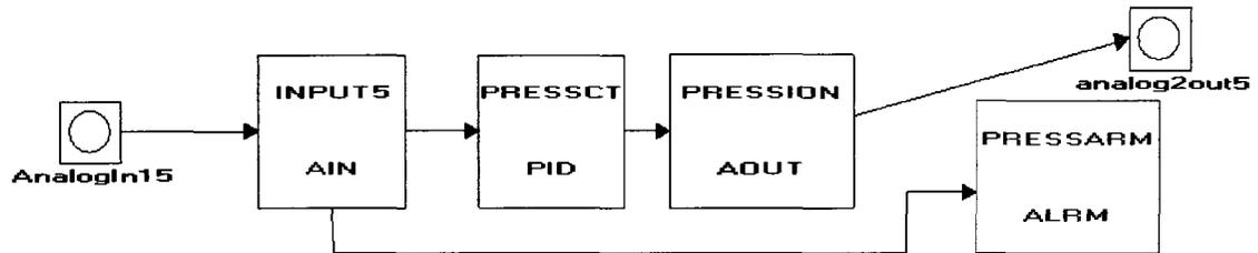
Figure 7.11 : La description du parcours des données pour contrôler la pression dans le condenseur en CS.
