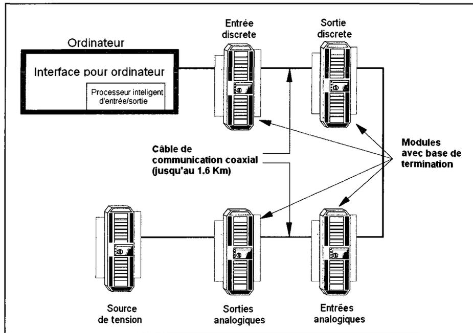
**Figure 5.1 : Exemple de modules couplés par un réseau de communication TransNet à une interface IIO**
