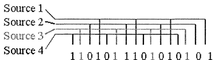
Figure I.8 : Principe du multiplexage dans le domaine temporel.
