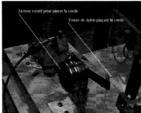
FIG. 2.1 Excitateur avec moteur pas-à-pas
