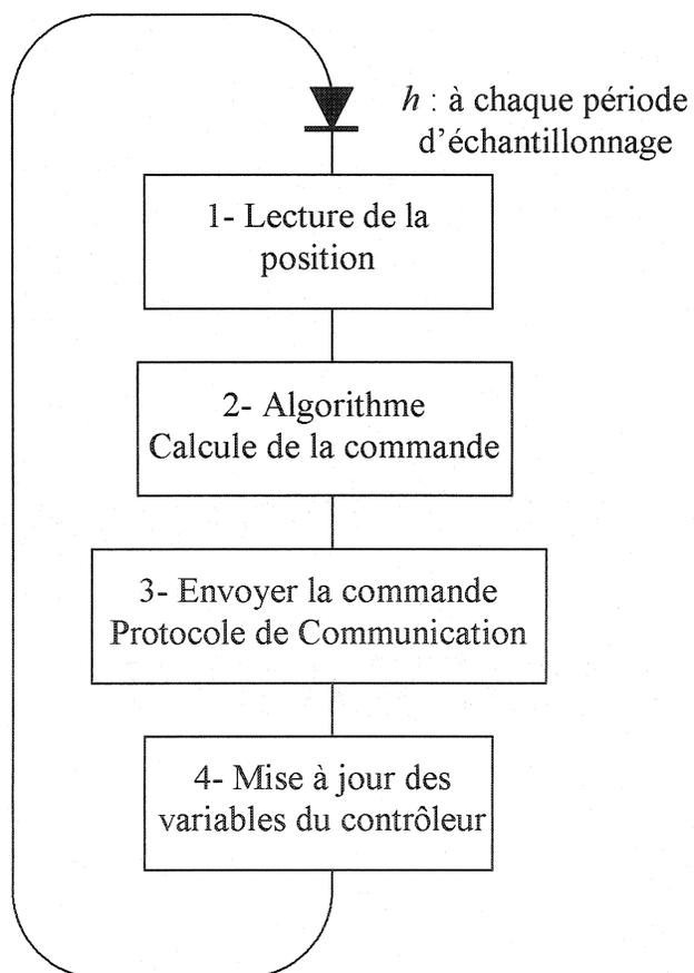
Figure 2.26 : Ordre d'exécution de l'algorithme du contrôleur discret.
