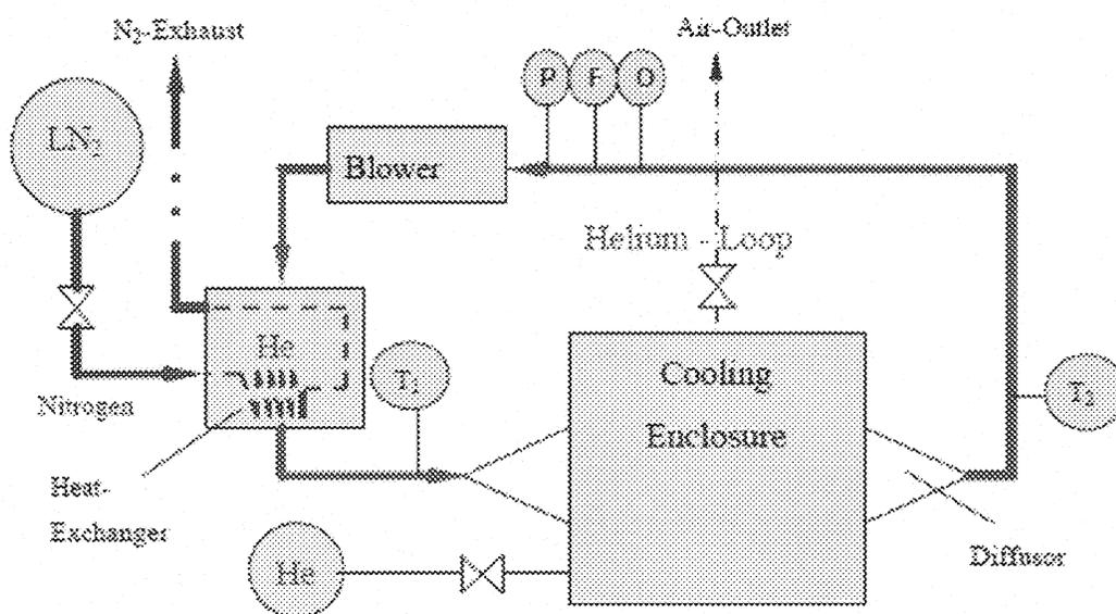
Figure 1.11 : Éléments du système de refroidissement [11].
