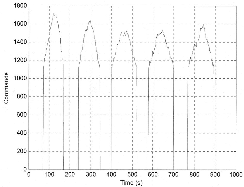
Figure 1.31 : Relais. Commande, consigne 20°C, puissance 10W/robot.
