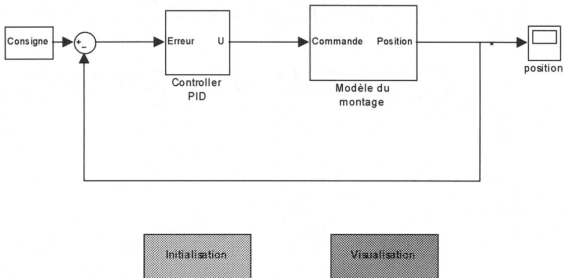
Figure 2.7 : Modèle de simulation du système à asservir.
