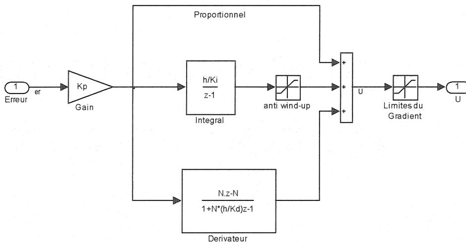
Figure 2.15 : Modèle de simulation du contrôleur discret.
