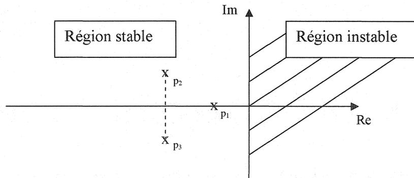
Figure 2.8 : Stabilité sur le diagramme de Laplace.
