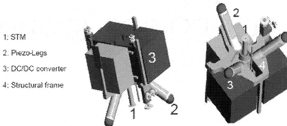
Figure 1.2 : Structure intérieure du NanoWalker [1].
