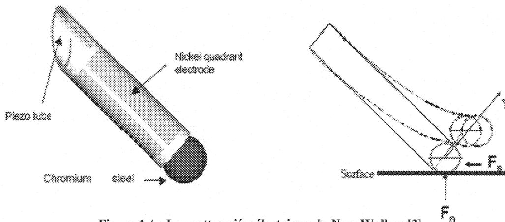
Figure 1.4 : Les pattes piézoélectrique du NanoWalker [3].
