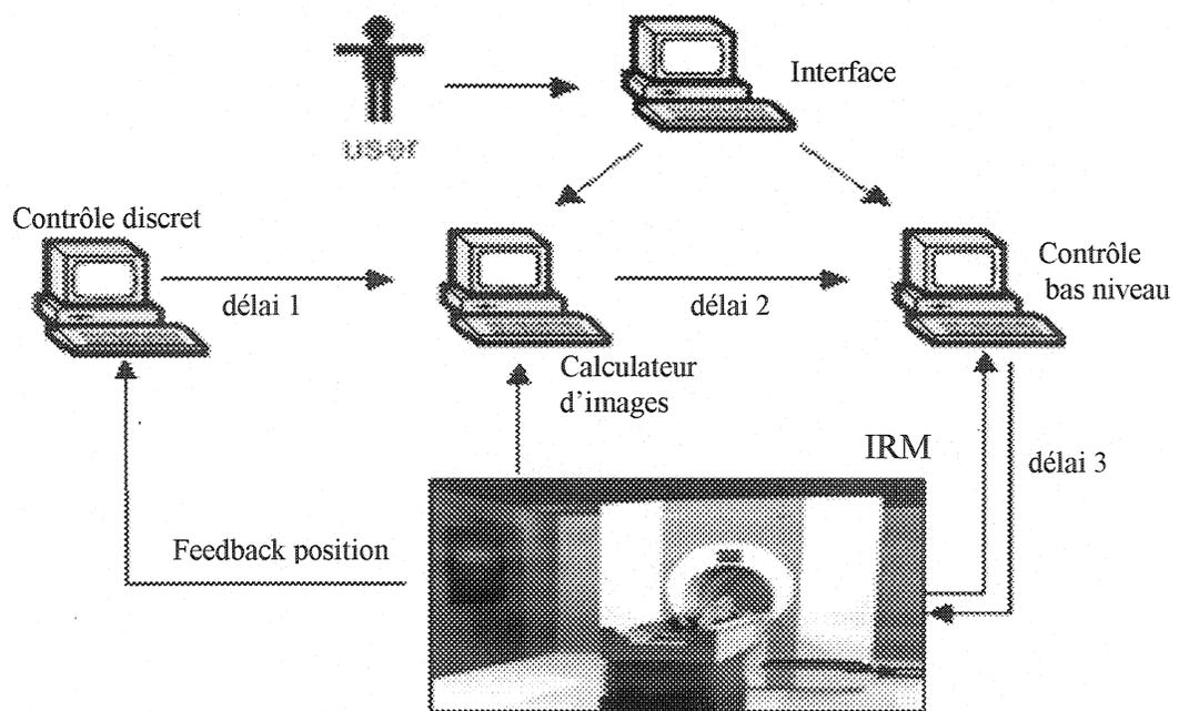
Figure 2.13 : Schéma du système IRM et contrôleur.
