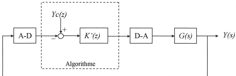
Figure 2.14 : Diagramme de blocs du contrôleur discret.
