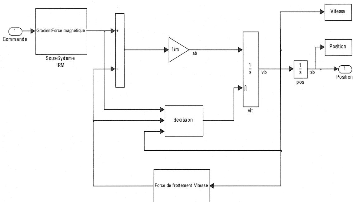
Figure 2.2 : Modèle de simulation du système.
