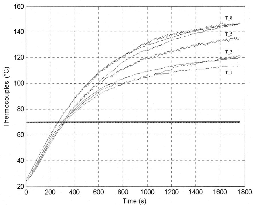
Figure 1.17 : Courbes d'échauffement à 15W/robot des huit thermocouples.
