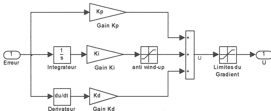
Figure 2.6 : Modèle de simulation du contrôleur PID analogique.
