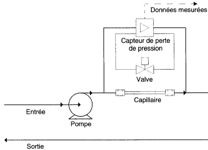
Figure 2.2 Schéma de l'appareil expérimental de mesure de la perte de pression
